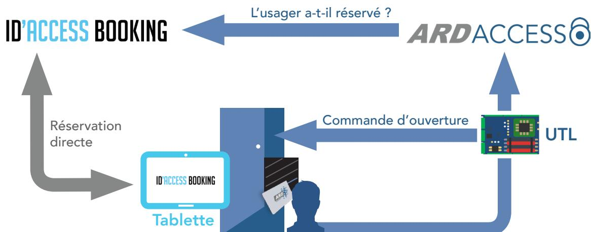
Le connecteur est optionnel, il assure une communication temps réel entre les deux applications. Lorsqu'un usager passe son badge devant le lecteur de contrôle d'accès de la salle, ARD Access interroge idAccessBooking qui déterminera si l'usager a bien réservé la salle dans le créneau horaire courant.
